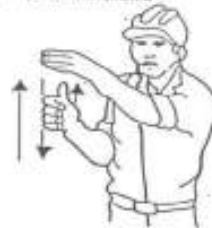
4 Levantar el aguilón o pluma lentamente
