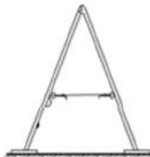
LAS ESCALERAS DE TUERA DEBEN DISPONER DE CUERDA O CADENA Y DE ZAPATAS ANTIDESLIZANTES
