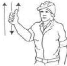
4 Levantar el aguilón o pluma lentamente
