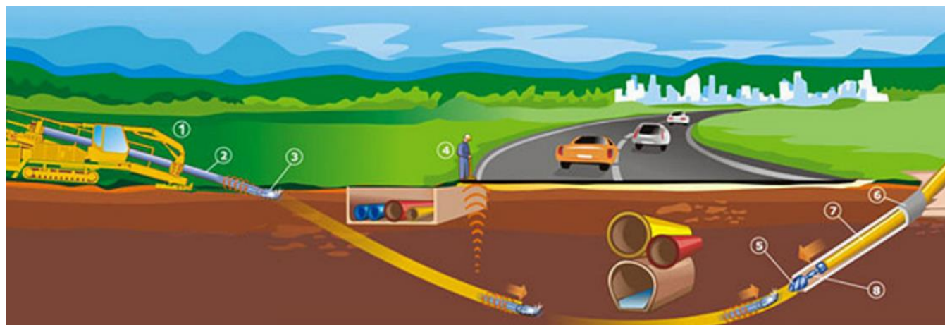
Figura 3 Esquema de perforación "topo"
