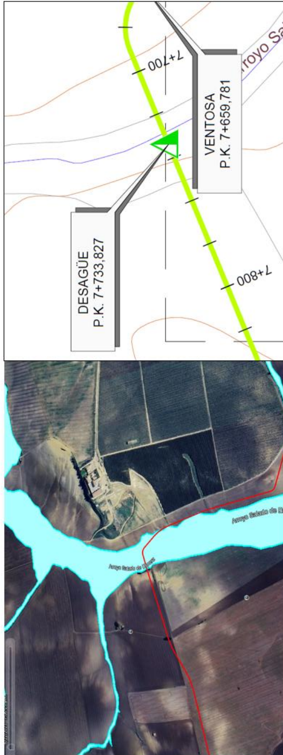
Figura 4. Detalle del cruce del arroyo Salado de Espera
