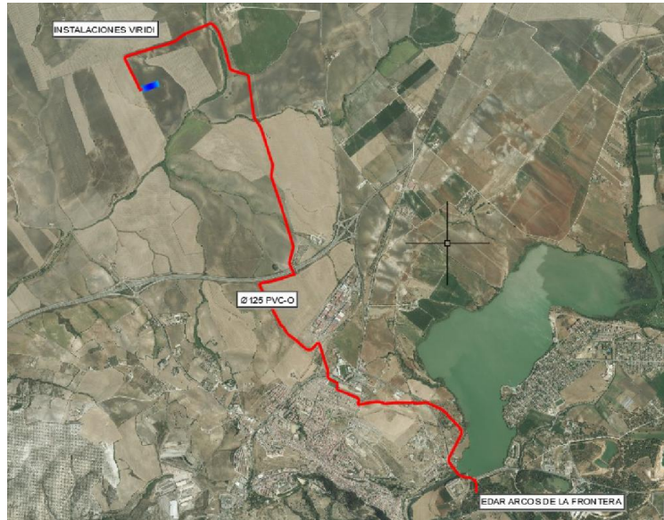
Figura 1 Trazado completo de la canalización.
