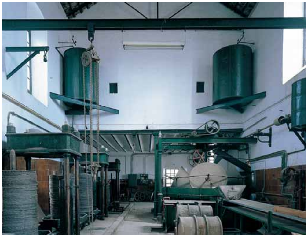
Nave de la fábrica de aceite, con el empiedro y las prensas hidráulicas.
