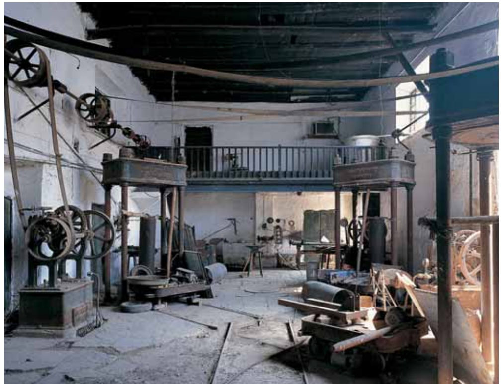
Nave de la almazara con prensas hidráulicas.
