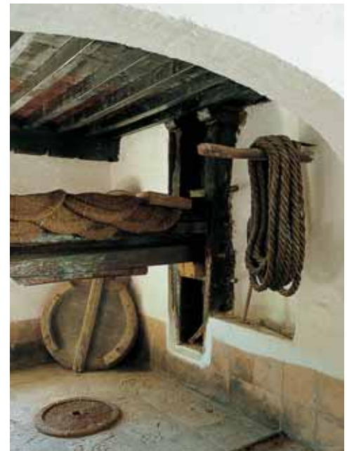
Detalle de la cabeza de la viga y de la capilla, hueco donde se introduce.
