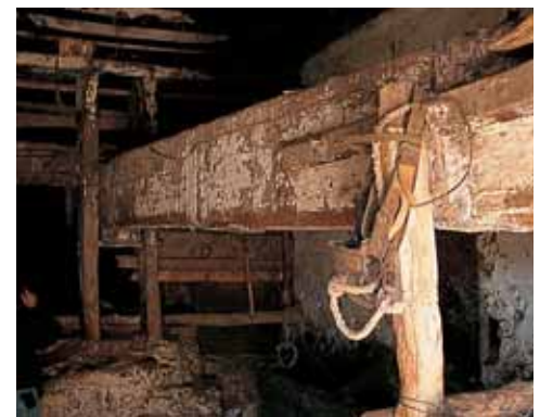
Viga de la prensa del lagar.
