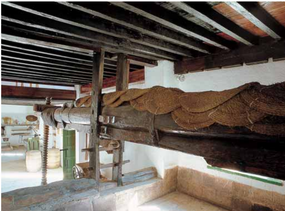
Detalle de la cabeza de la viga y de la capilla, hueco donde se introduce.
