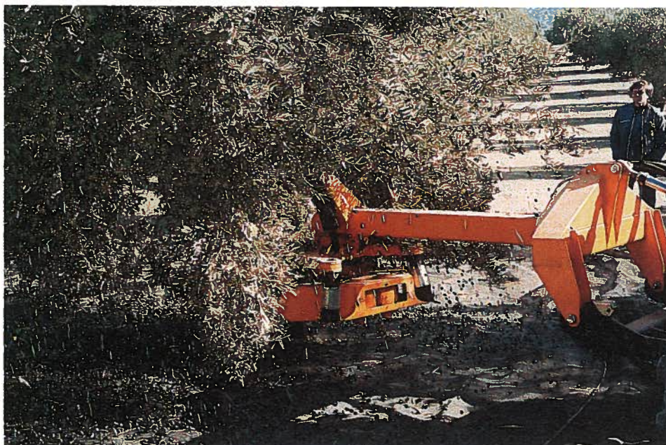
Derribo de aceituna con vibrador acoplado a tractor
