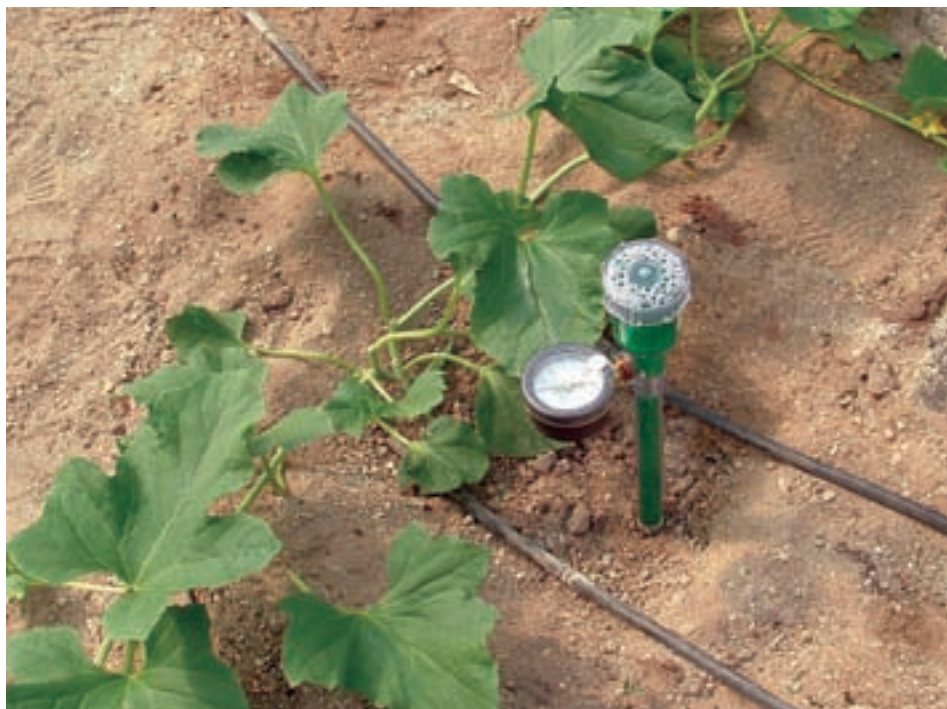
Fig. 69.- Utilización de tensiómetros en cultivo de melón
