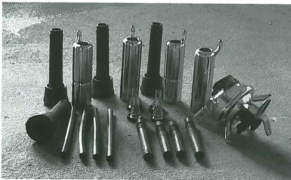
Figura 1.- Elementos de un juego de ordeño
